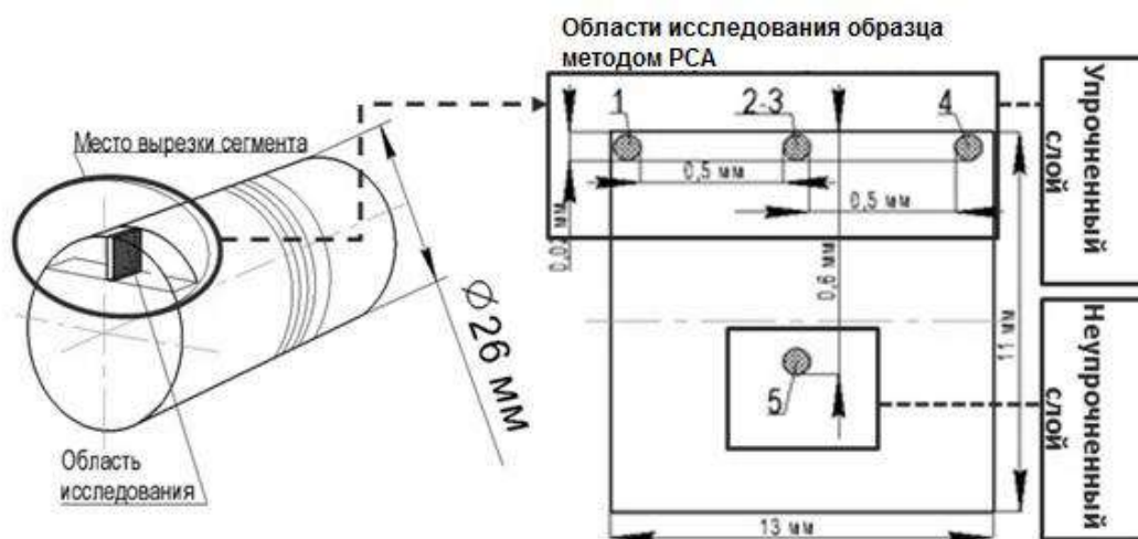
Рисунок 1.2 – Схема исследования образцов методом РСА: 1 – точка сканирования (левый, верхний край шлифа, упрочненный слой), 2-3 – точки сканирования (середина шлифа, упрочненный слой), 4 – точка сканирования (правый, верхний край шлифа, упрочненный слой), 5 – точка сканирования (центр шлифа, неупрочненный слой)
