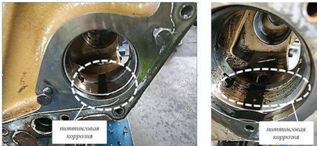
Рисунок 6 – Питтинговая коррозия на втулках распределительных валов двигателя Cummins KTA 50 газодизельного карьерного самосвала БелАЗ 75131
