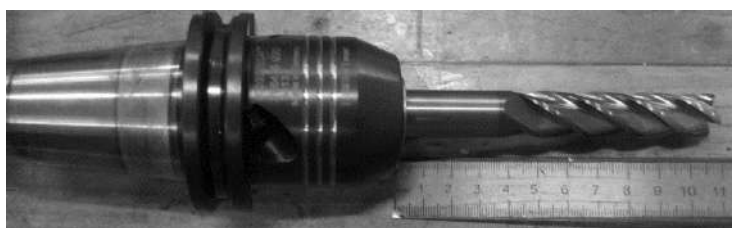
Рисунок 5 – Фреза в гидropатроне
