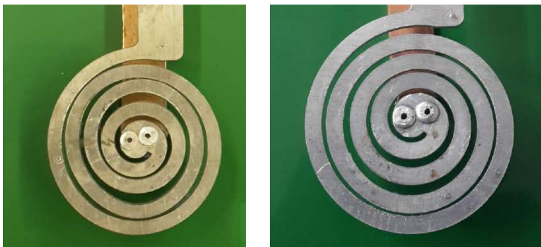
Рисунок 4 – Деформация индукторов из алюминиевой спирали после серии импульсов
