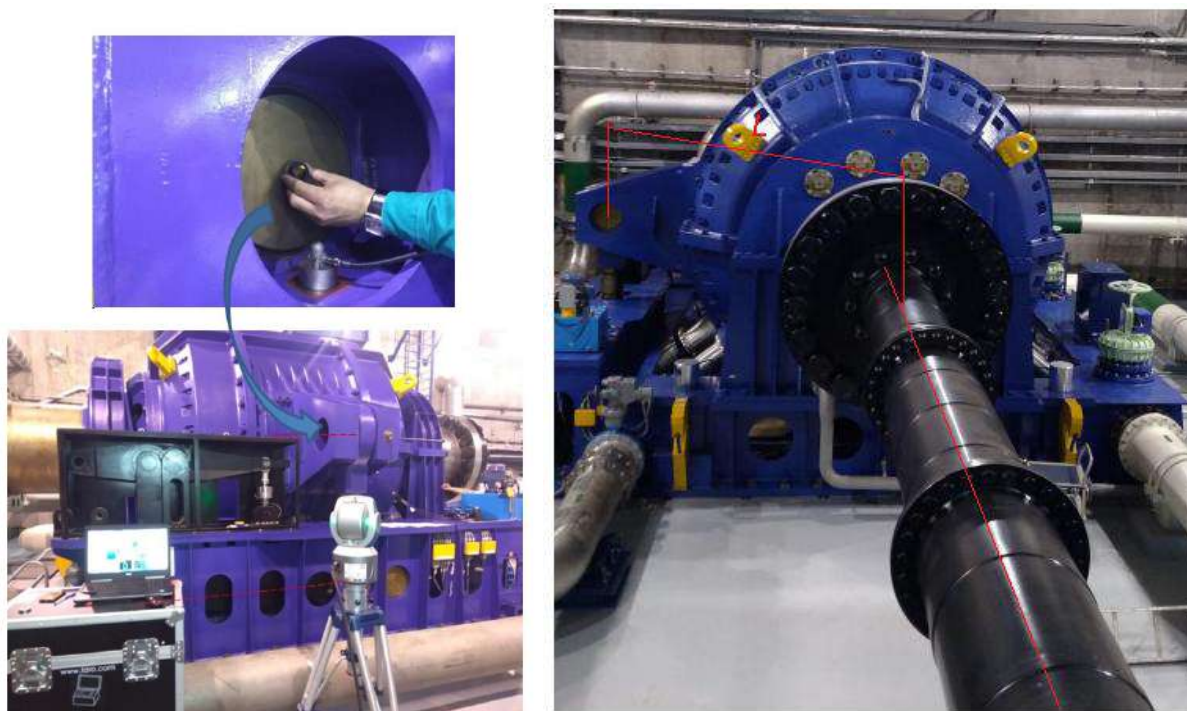
Рисунок 6 – Определение размера L – рычага ГД, передающего Мкр на силоизмерительную систему (см. рис. 3)
