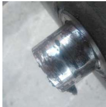
Рисунок 3 – Изношенная ось крепления управляемого моста
