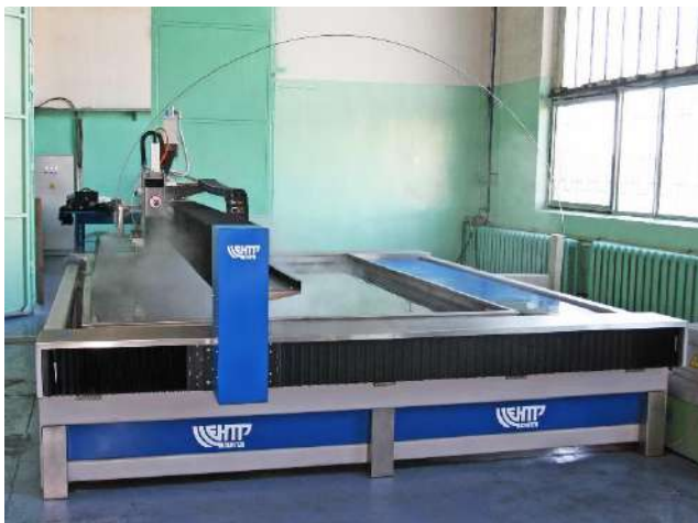
Рисунок 3 – Технологический комплекс гидроабразивной резки
