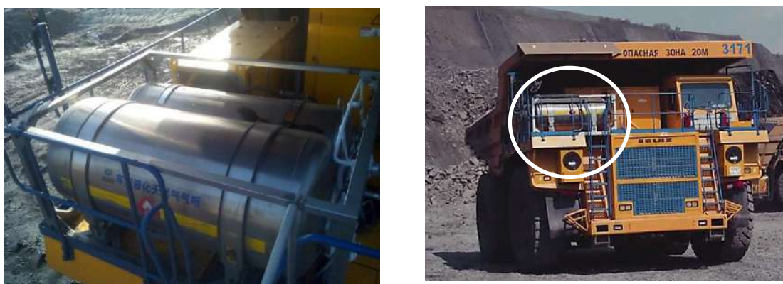
Рисунок 7 – Два горизонтальных криогенных топливных бака объёмом: 850 и 500 литров, установленные на палубе карьерного самосвала БелАЗ 75131
