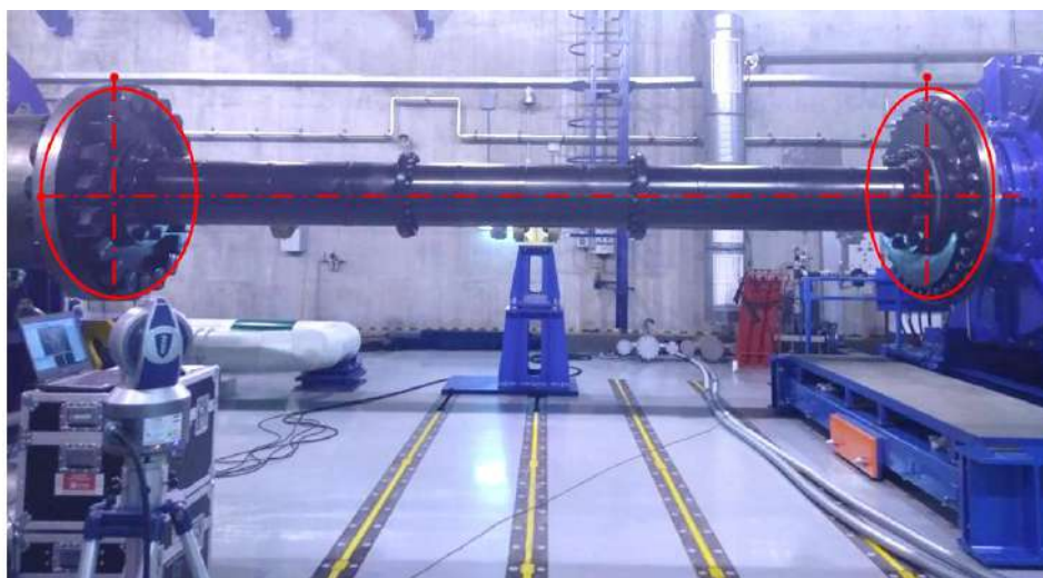
Рисунок 5 – Определение измерительной базы – оси ГД (расположен слева) связанного через валопровод со стендовым редуктором (расположен справа)
