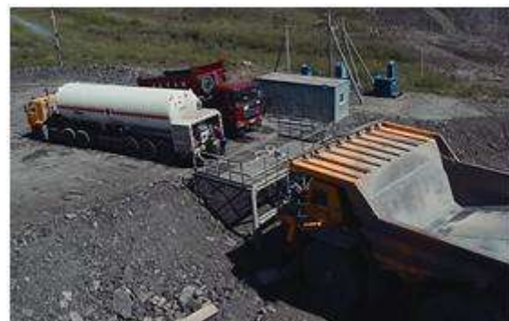
Рисунок 2 – Стационарная площадка для заправки карьерных самосвалов сжиженным природным газом
