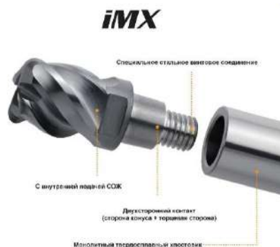
Рисунок 3 – Внешний вид составной фрезы Mitsubishi
