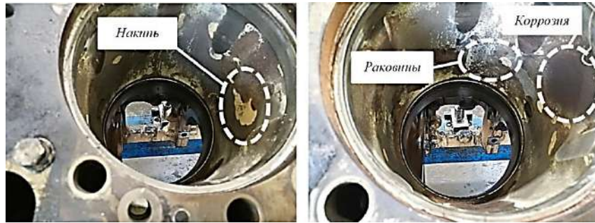
Рисунок 1 – Поверхности охлаждающих рубашек блока цилиндров со стороны ОЖ двигателя Cummins KTA 50 газодизельного карьерного самосвала БелАЗ 75131
