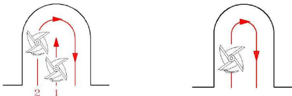
Рисунок 2 – Фрезерования по контуру паза с предварительным центральным проходом (а) и без него (б)
