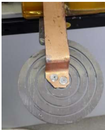
Рисунок 2 – Схема присоединения медного токовывода к центру алюминиевого индуктора
