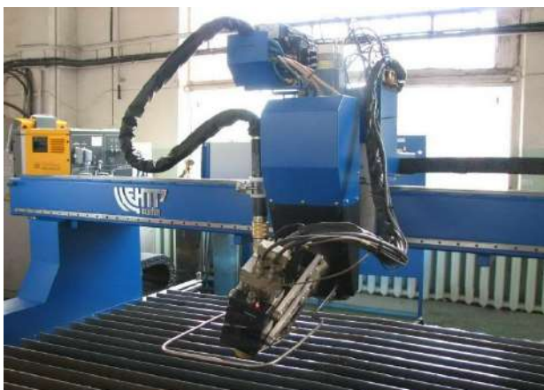
Рисунок 1 – Технологический комплекс плазменного раскроя материала с Манипулятором для резки и разделки кромок заготовок под углом
