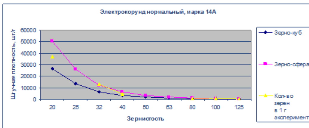
Рисунок 5 – Графическая зависимость штучной плотности от зернистости электрокорунда нормального 14А
