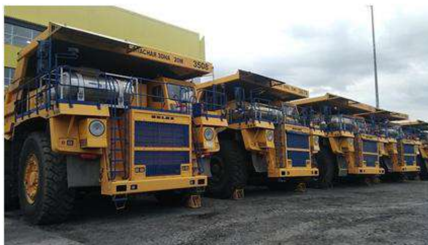
Рисунок 3 – Модернизированные для эксплуатации по газодизельному циклу карьерные самосвалы БелАЗ 75131
