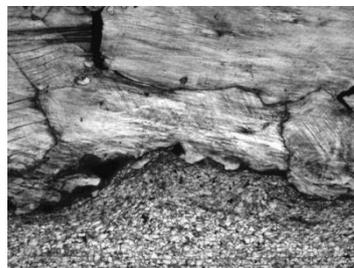
Рис. 5. Дефекты в стали Гадфильда после сварки взрывом
