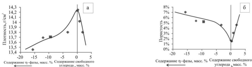
Рис. 2. Зависимости плотности (а) и пористости (б) от содержания η-фазы или углерода в ультрамелкозернистом сплаве WC-8Co-0.4VC-0.4Cr<sub>3</sub>C<sub>2</sub> после обработки заготовок в газовой смеси (♦) и без обработки (■)
