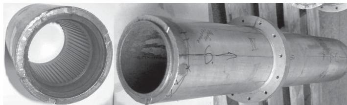
Рис. 1. Эскиз и фото поломки вертикального вала винто – рулевой колонки судна
