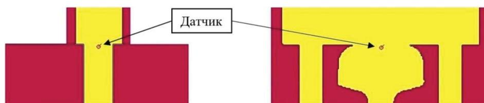
Рис 2. Место установки датчика в головке рельса сварного шва
