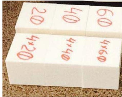
б – образцы для испытания на сжатие
