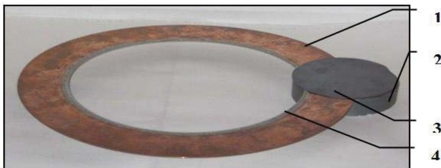
Рис. 4. Резка слитка кремния на проход инструментом без механических опор
