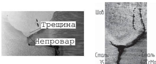
Рис. 4. Макроструктура и микротрещины в сечении неразрушенного сварного соединения
