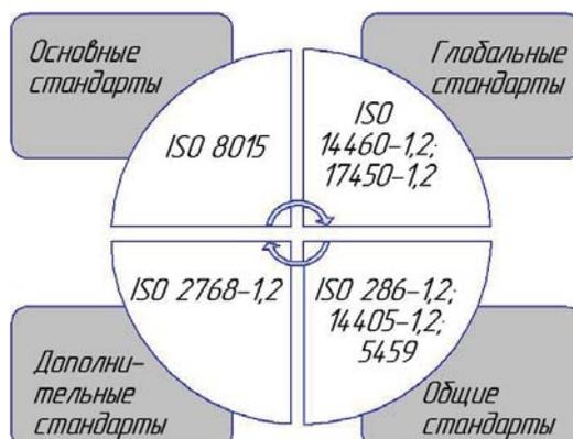
Рис.1. Стандарты ISO по размерной и геометрической точности
