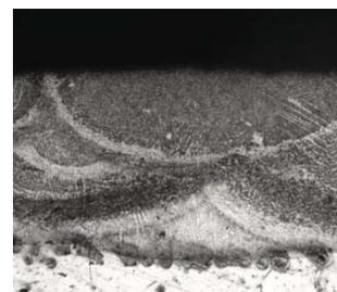
Рис. 2. Поперечное сечение двухслойного мультимодального покрытия x50
