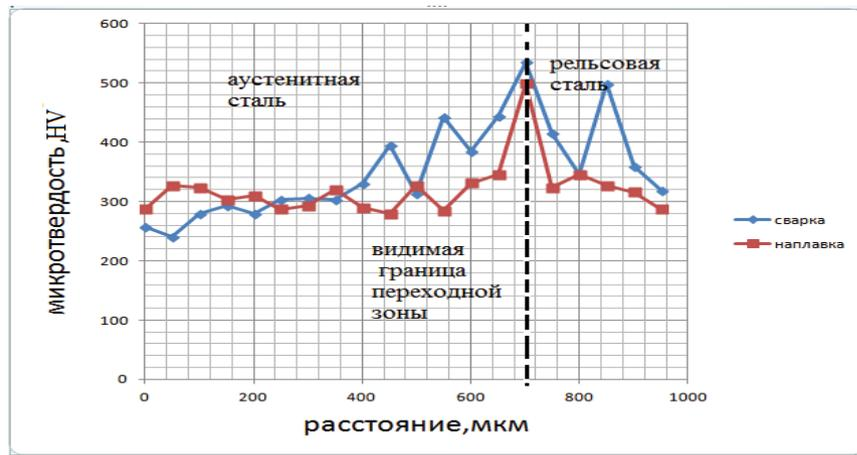
Рис. 3. Распределение микротвердости на границе взаимодействия разнородных сталей
