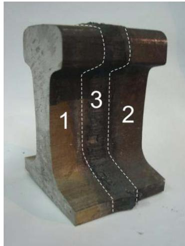
*Рис. 1.* Комбинированное сварное соединение, полученное стыковой контактной сваркой при производстве сварных крестовин:
