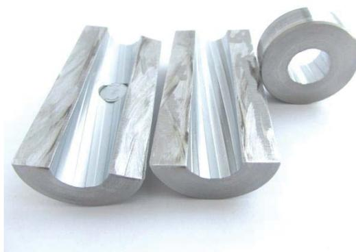
Рис. 3. Образцы хромового покрытия
