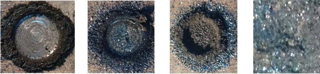
Рис. 6. Цвета побежалости железа входящего в состав композиционного материала
