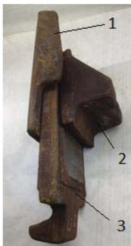
Рис. 1. Фрикционный узел:
