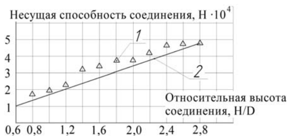
1 – экспериментальные значения 2 – аппроксимирующая зависимость Рисунок 3 – Зависимость несущая способность соединения от относительной высоты
