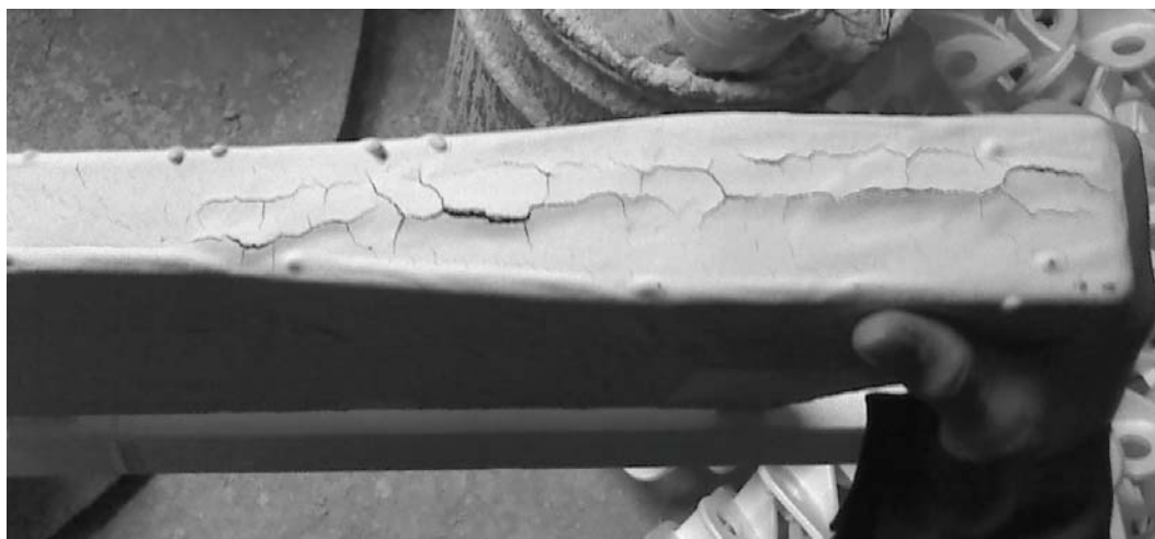
Рисунок 2 – Результат нарушение технологии сушки противопопригарного покрытия
