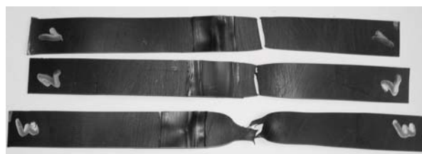
Рисунок 3 – Разрушение соединения по зоне очистки при экструзионной сварке
