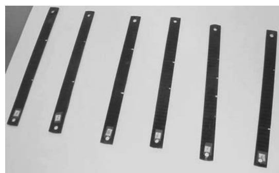
Рисунок 4 – Образцы стоек рам, идеализированной формы, из углепластика со сквозными дефектами
