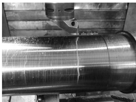
Рисунок 2 – Поверхность вала со следами волнистости
