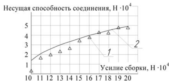
1 – экспериментальные значения 2 – аппроксимирующая зависимость Рисунок 4 – Зависимость несущей способности соединения от усилия сборки
