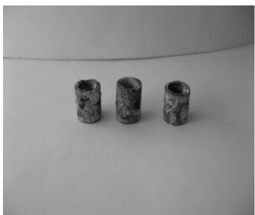
Рисунок 3 – Образцы с покрытием на основе оксида цинка и асбеста после испытаний.
