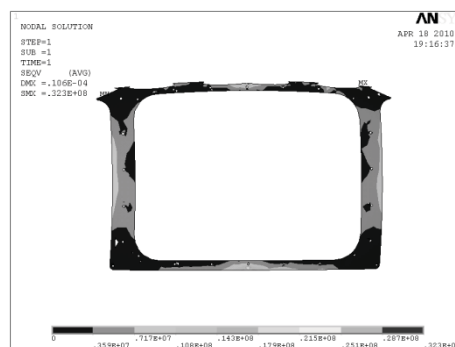
Рисунок 7 – Расчет на прочность при равномерном давлении отдельной рамы из композиционного материала в системе ANSYS
