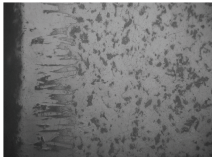
Рисунок 4 – Микроструктура борированной стали после нормализации (травление 4% раствором азотной кислоты в этиловом спирте), \times 200
