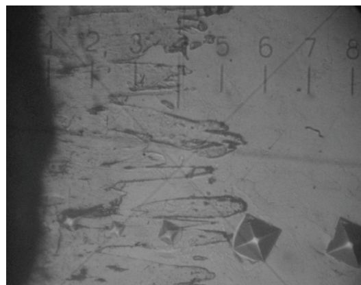
Рисунок 6 – Структура борированного слоя после закали
